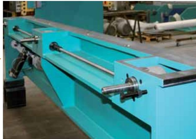
Моторизованная регулировка зазора между лезвиями.
