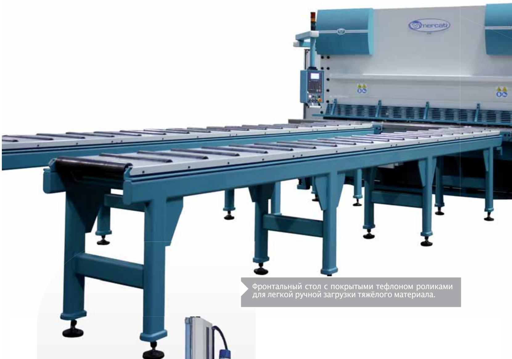
Фронтальный стол с покрытыми тефлоном роликами для легкой ручной загрузки тяжелого материала.
