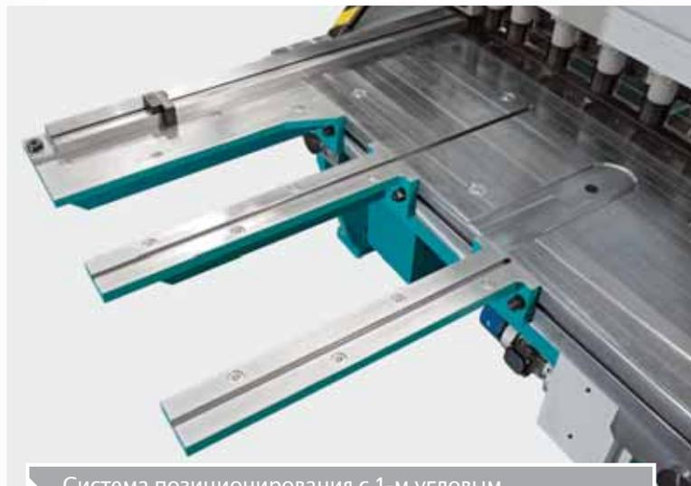
Система позиционирования с 1-м угловым направляющим суппортом и 2-ми фронтальными суппортами с убирающимися упорами и шариками.
