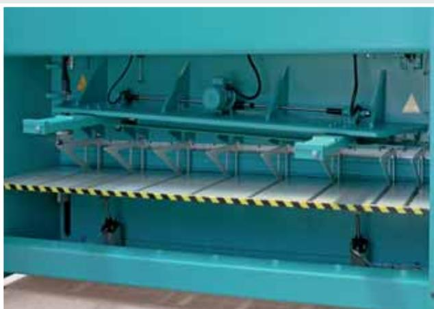
Двойной пневматический держатель листа до 6 мм с системой предотвращающей цапаины материала.
