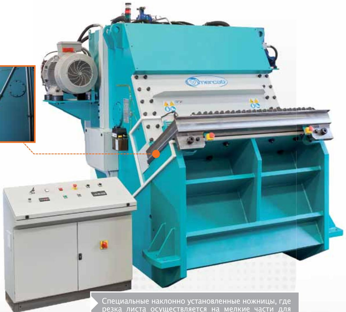
Специальные наклонно установленные ножницы, где резка листа осуществляется на мелкие части для отправки на переплавку (например, никель).
