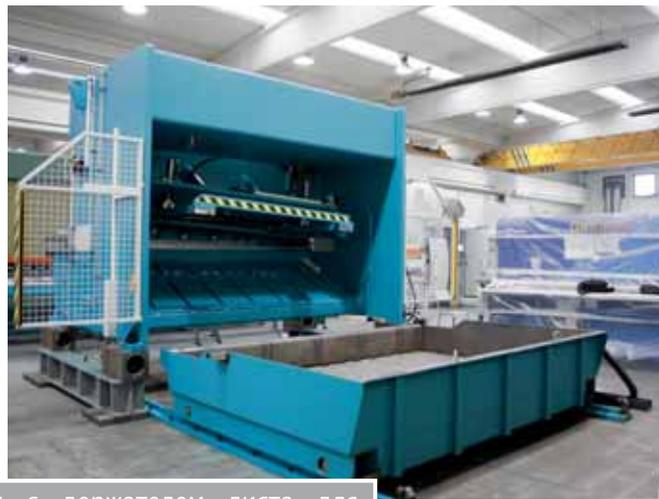
Гильотинные ножницы с держателем листа для тяжёлого материала, гидравлически откидывающимся задним упором и моторизованной системой выгрузки.
