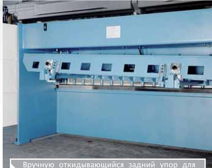
Вручную откидывающийся задний упор для отрезки деталей превышающих стандартную величину хода заднего упора.
