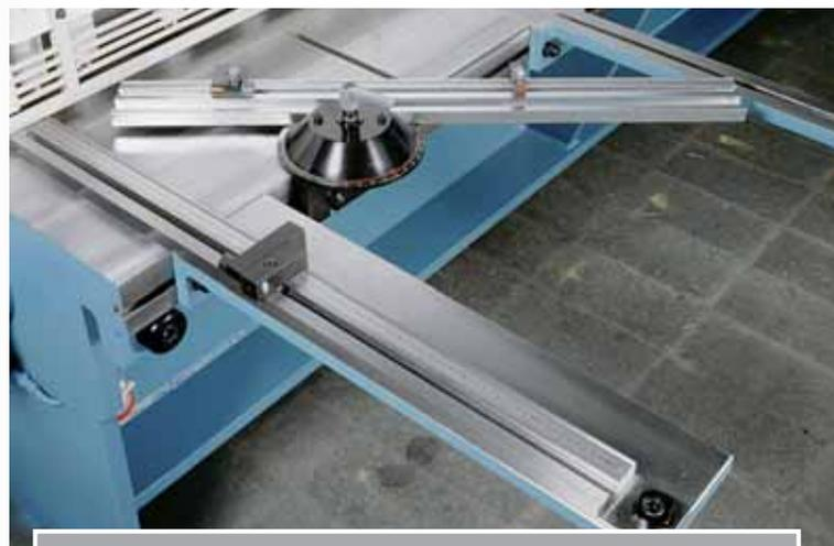
Угловой направляющий суппорт с упором и устройством резки под углом.
