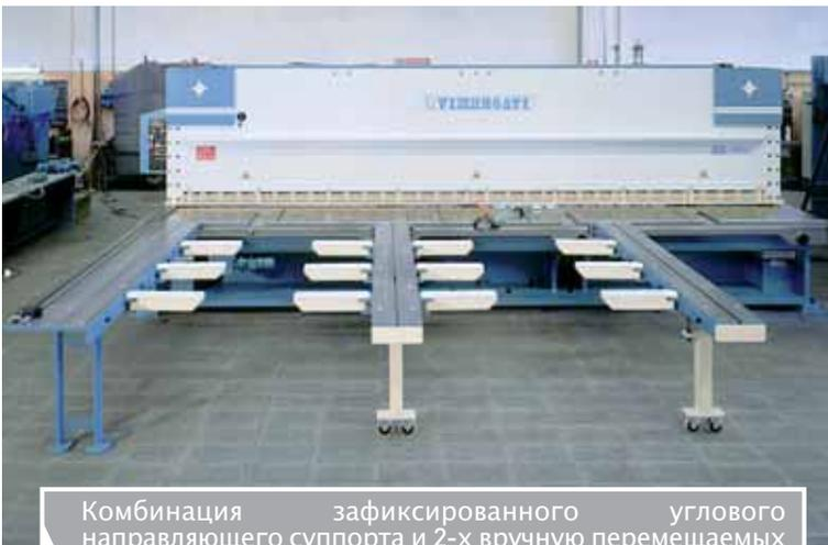
Комбинация зафиксированного углового направляющего суппорта и 2-х вручную перемещаемых фронтальных суппортов. Для легкой регулировки по длине и исключения падения листа, угловой и фронтальные суппорты укомплектованы также перемещаемыми боковыми поддержками. Оператор может перемещать 2 фронтальных суппорта в оптимальную рабочую позицию.
