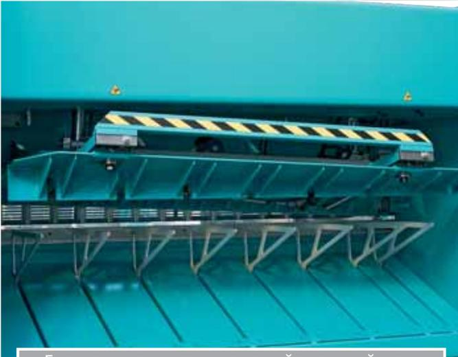
Гидравлически откидывающийся задний упор для отрезки деталей превышающих стандартную величину хода заднего упора.
